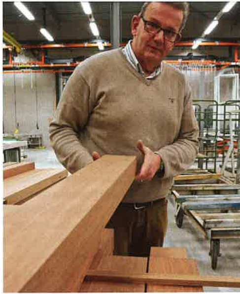
Meranti van minimaal 450 kg/m 3 vormt de noodzakelijke basis van een degelijk kozijn dat jaren meegaat.
